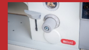
线迹调节旋钮（线迹长度可调） 最大针码9mm Stitch length adjustment knob (adjustable stitch length) up to 9mm
